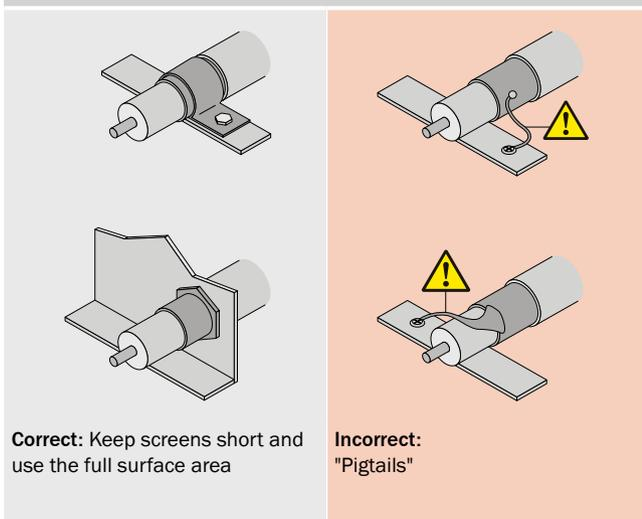
Example: Providing equipotential bonding
